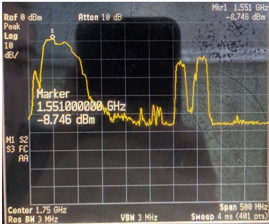
Slika 5.5. Rezultati mjerenja sa uključenim uređaj za ometanje signala.
