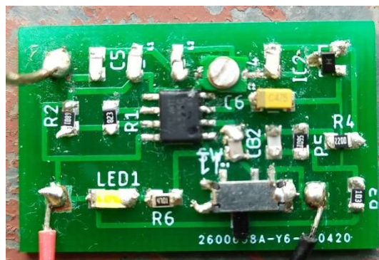
Slika 5.3. Detaljan izgled sklopa uređaja za ometanje signala.
