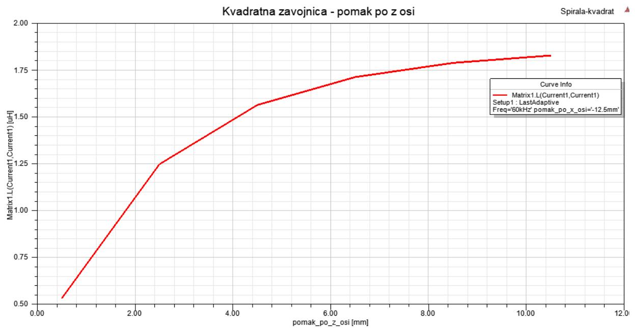
Slika 5.17. Promjena induktiviteta pomakom po z osi
