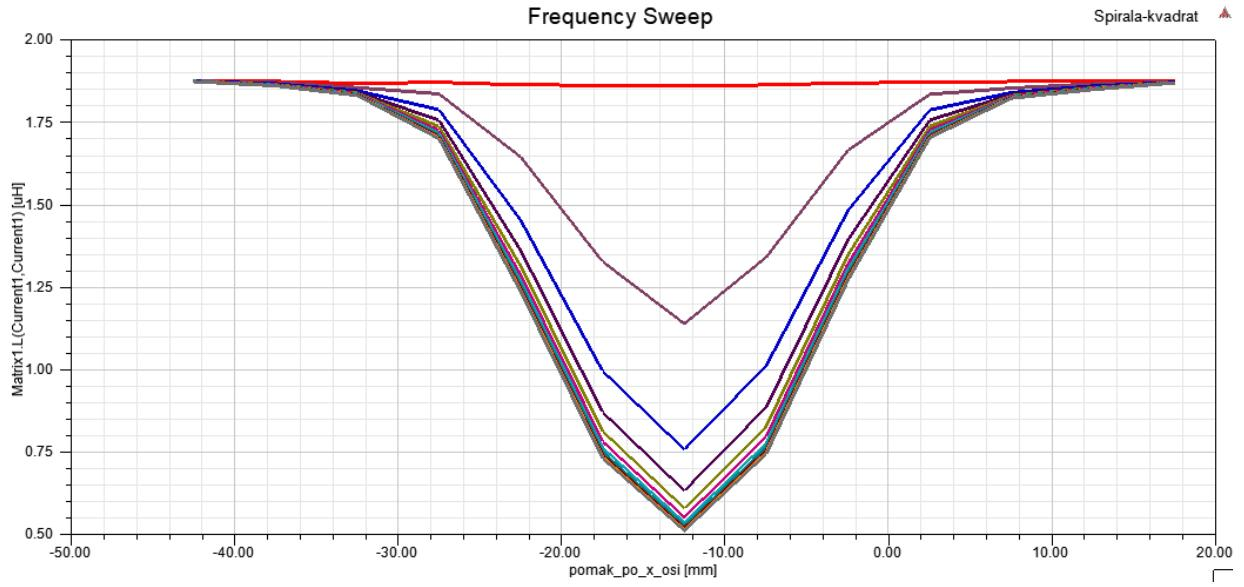
**Slika 5.6.** Prikaz osjetljivosti senzora za različite frekvencije
