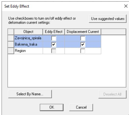
**Slika 5.1.** Definiranje vrtložnih struja u bakrenoj traci
