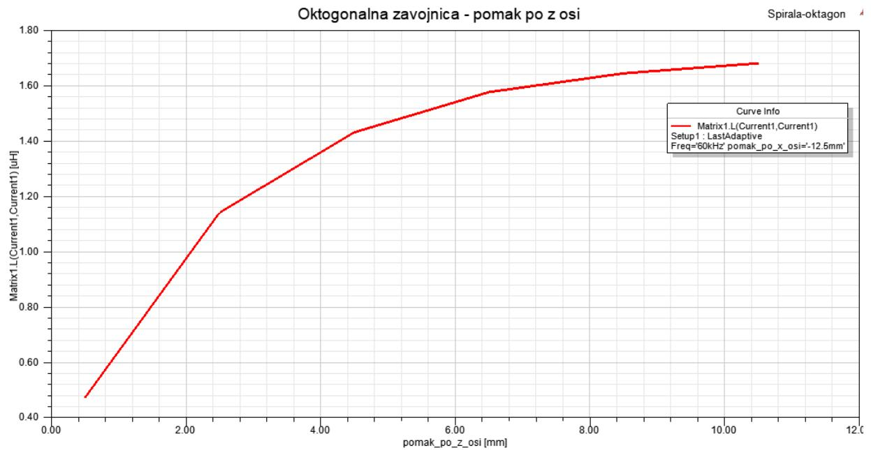
**Slika 5.27.** Promjena induktiviteta pomakom po z osi
