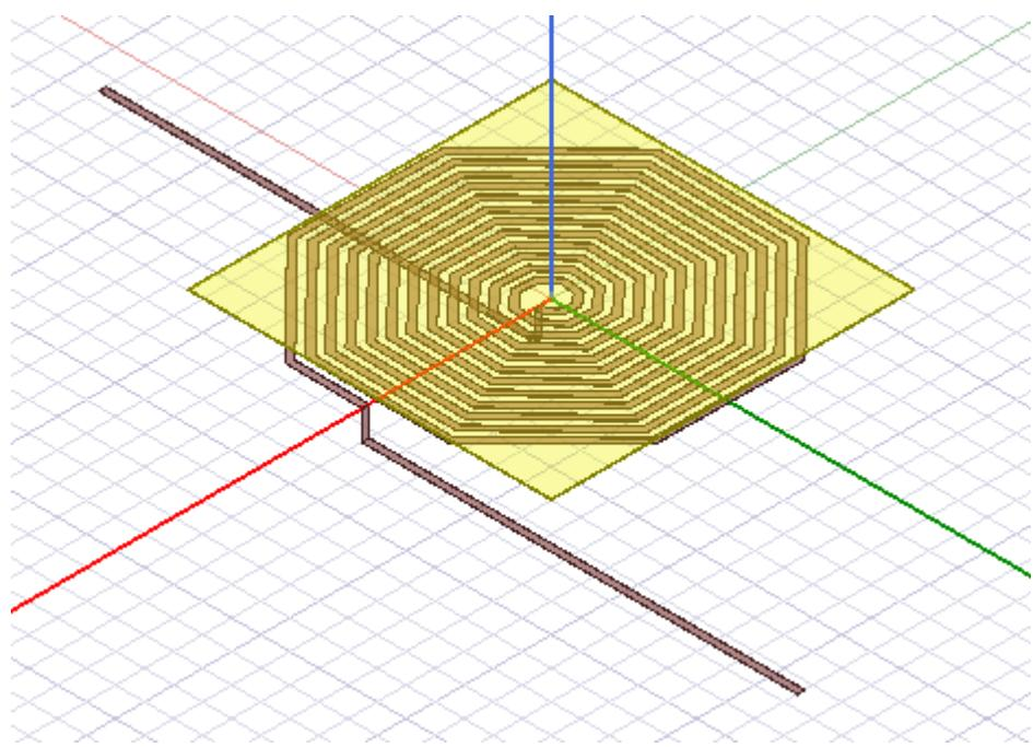
**Slika 4.13.** Kompletna oktogonalna geometrija sa bakrenom trakom
