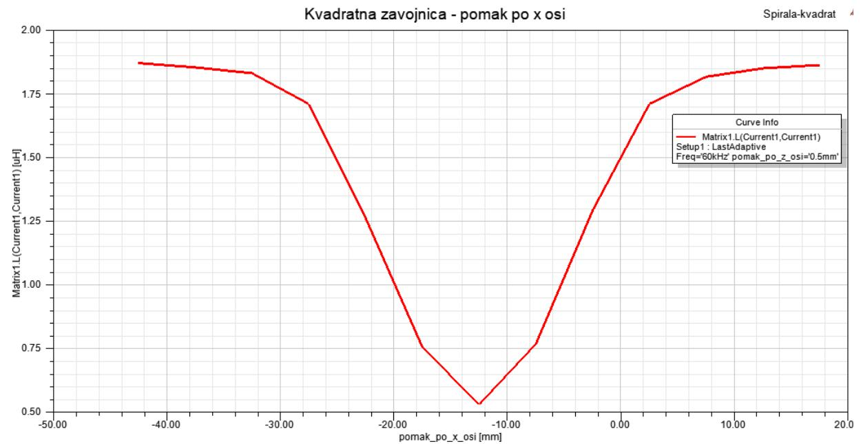
**Slika 5.16.** Promjena induktiviteta pomakom po x osi
