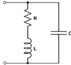
**Slika 3.3.** RLC krug s paralelnim kapacitetom [1]
