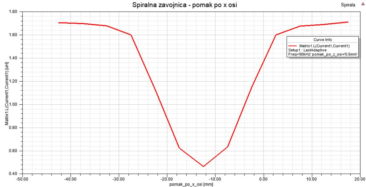
Slika 5.11. Promjena induktiviteta pomakom po x osi
