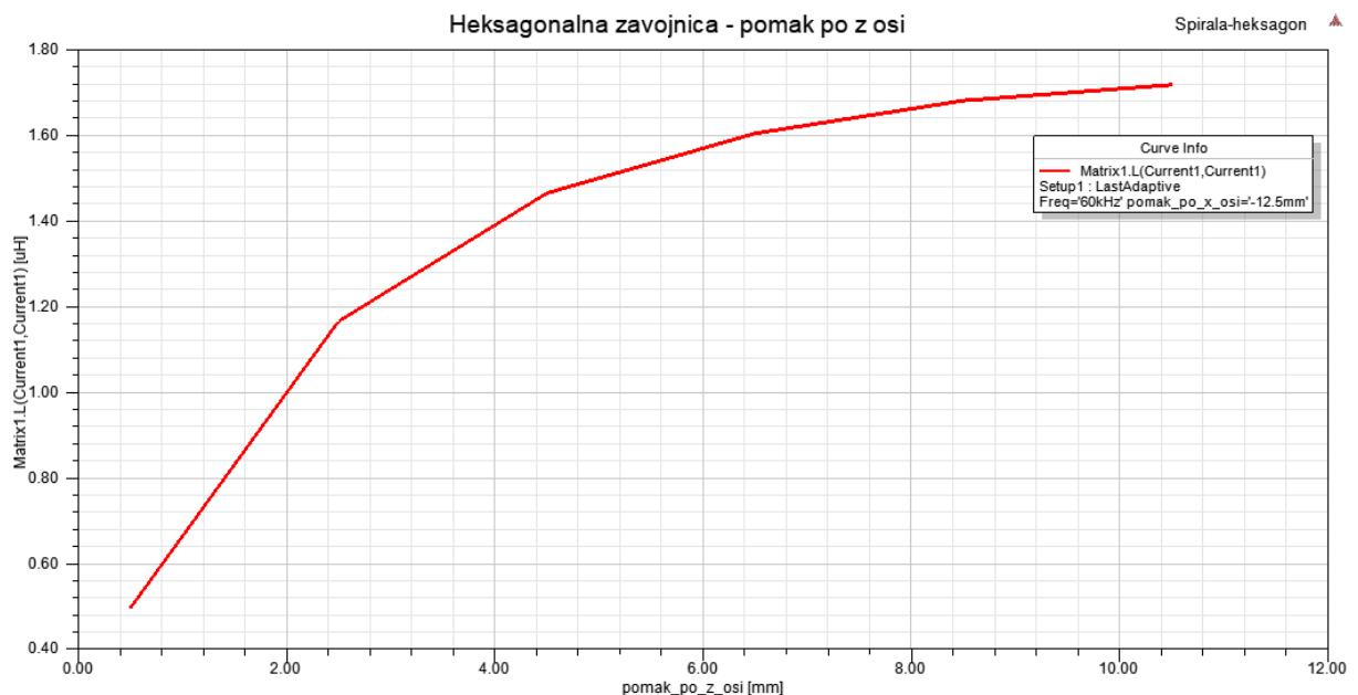
**Slika 5.22.** Promjena induktiviteta pomakom po z osi
