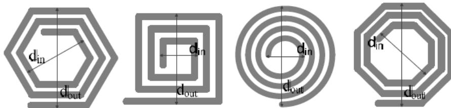
**Slika 6.1.** Određivanje unutarnjeg i vanjskog promjera [4]
