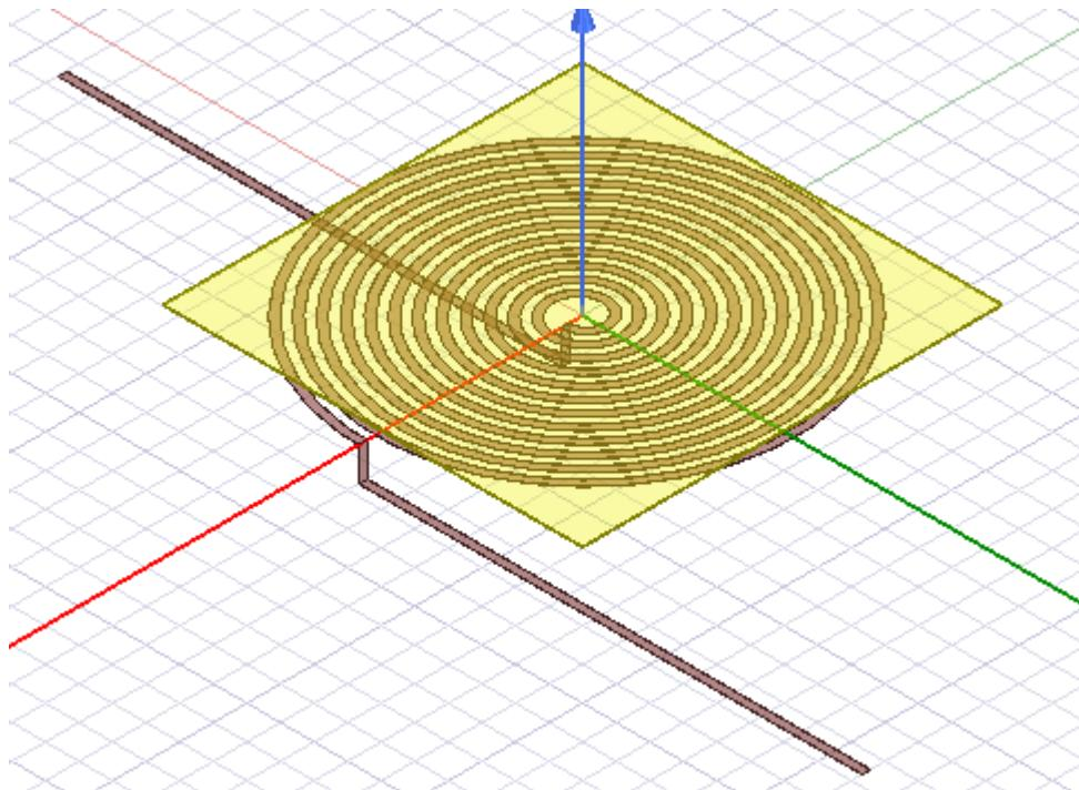
**Slika 4.10.** Kompletna spiralna geometrija sa bakrenom trakom
