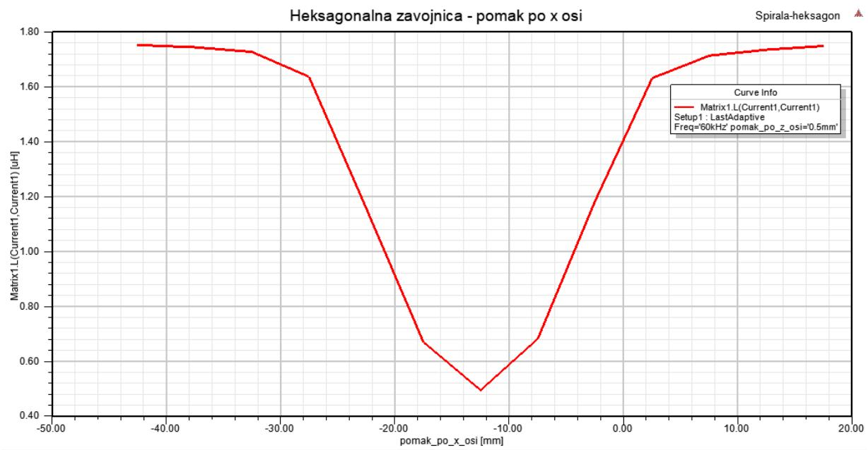
**Slika 5.21.** Promjena induktiviteta pomakom po x osi
