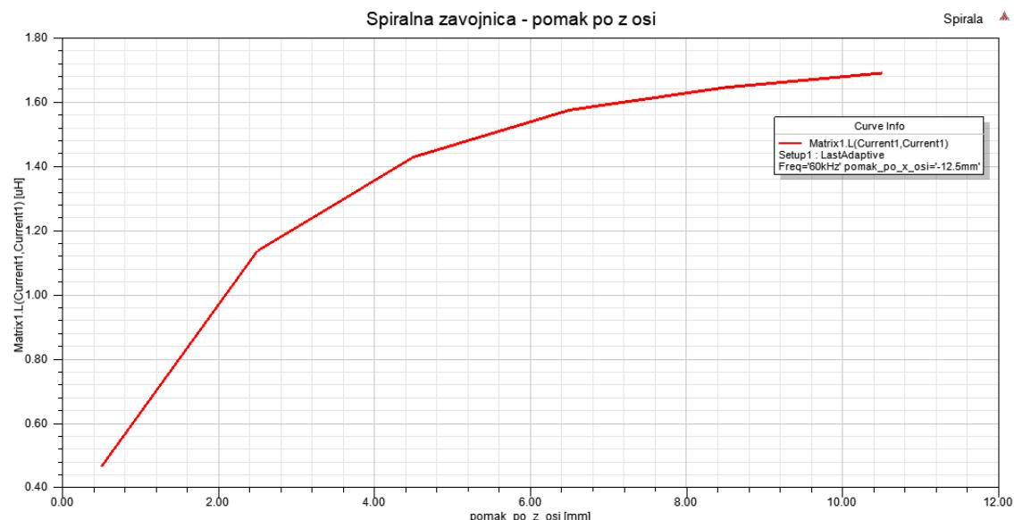
Slika 5.12. Promjena induktiviteta pomakom po z osi
