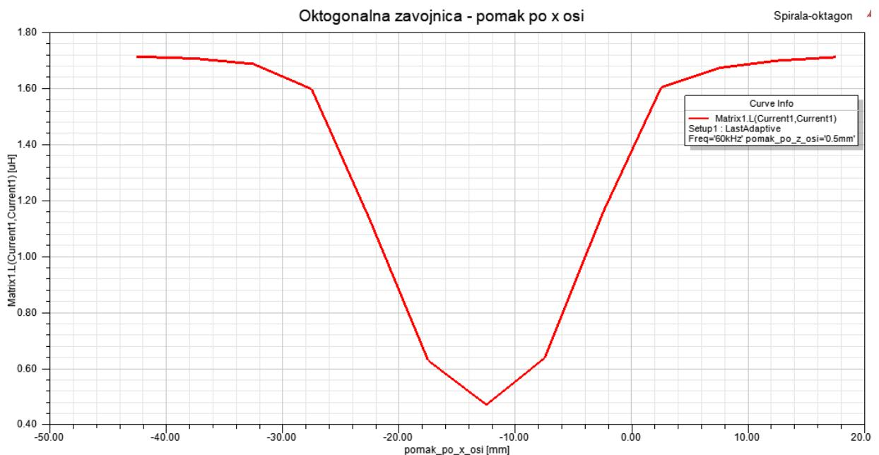
**Slika 5.26.** Promjena induktiviteta pomakom po x osi
