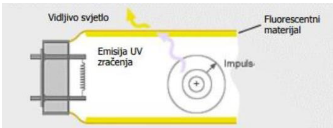
Slika 4.6. Pojednostavljeni prikaz principa rada fluorescentne cijevi
