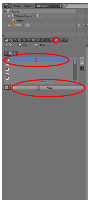
SI. 2.12 Izrada nove prazne teksture (1 – Izbornik za teksture, 2 – Lista tekstura za trenutni materijal, 3 – Gumb za stvaranje nove teksture).
