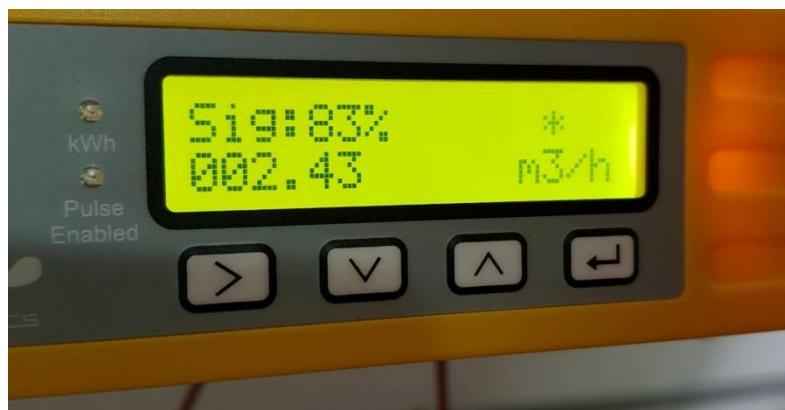
Slika 5.6. Prikaz snage signala i protoka.
