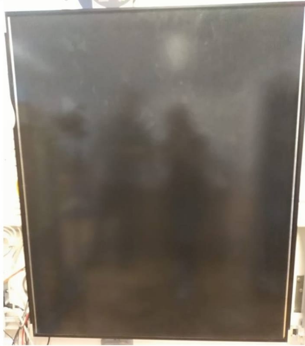
Slika 2.7. Fotonaponski modul – amorfni silicij
