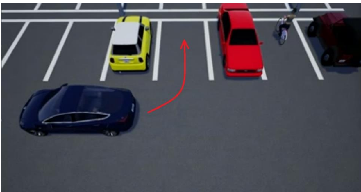
Sl. 4.10. Putanja vozila prilikom parkiranja desno unatrag iz jednog manevra
