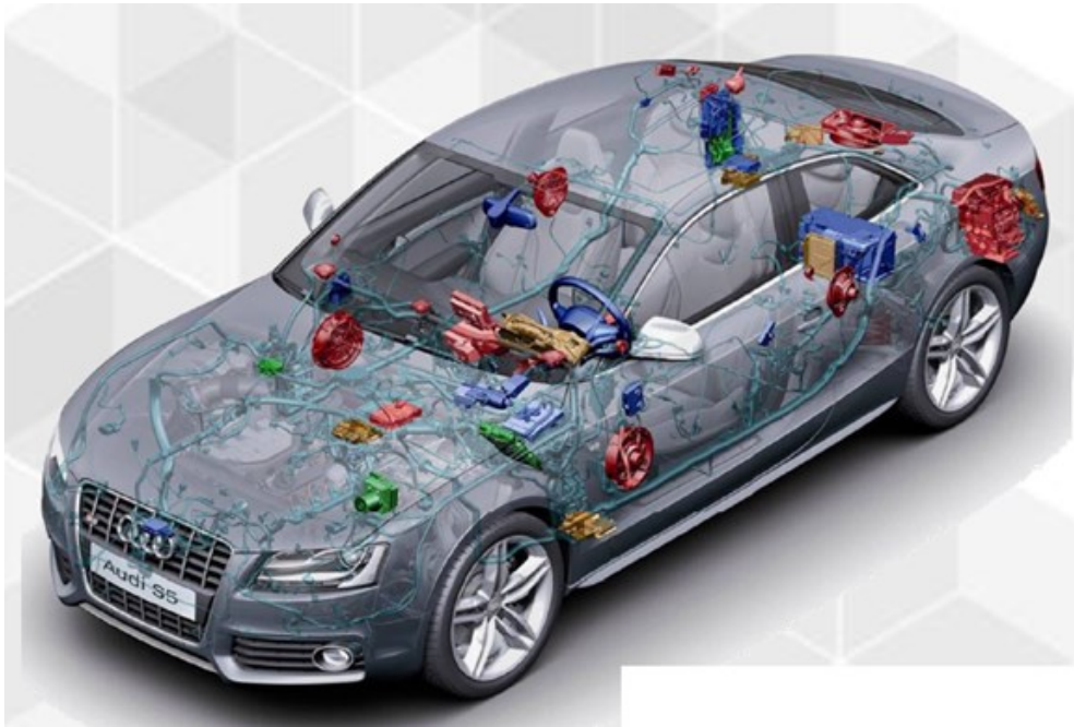
Slika 2.6. Primjer korištenja više različitih vrsta senzora, aktuatora i signalizacije u automobilu
