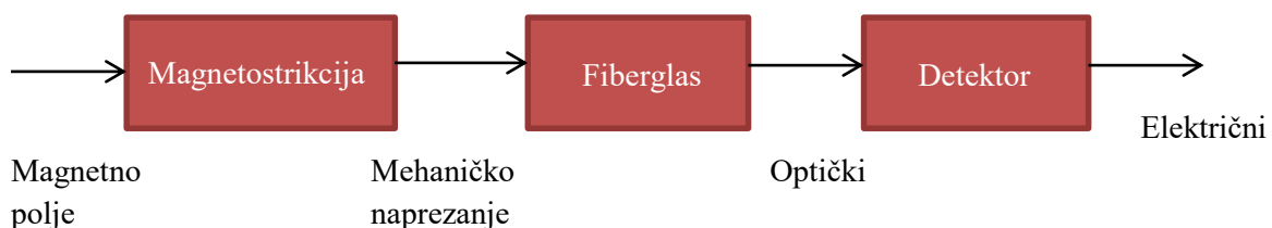
Slika 2.9. Shema senzora fiberoptičkog magnetnog polja
