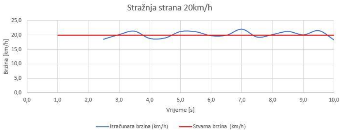
Slika 4.56. Prikaz brzine za stražnju stranu automobila pri brzini 20km/h
