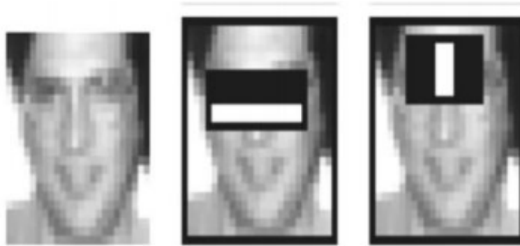
Sl.2.10. Primjena Haarove značajke na ulaznu sliku (rubna značajka se koristi npr. za detekciju očiju, a linijska za detekciju nosa) [15].
