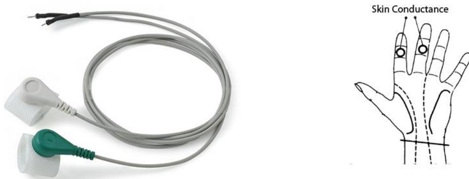
**Sl. 4.13** Senzori za mjerjenje elektrodermalne aktivnosti [17]
