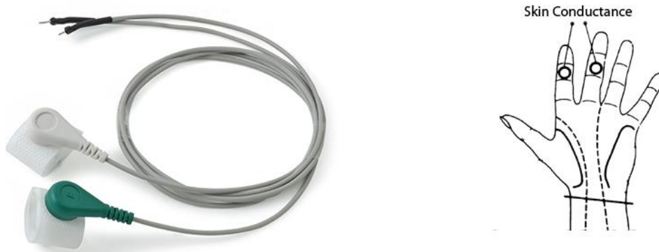
Sl. 4.13 Senzori za mjerenje elektrodermalne aktivnosti [17]
