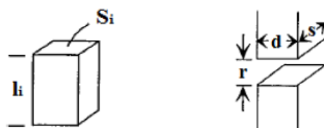
Slika 2.7. Puni element (lijevo na slici), element s zračnim rasporom (desno) [12]
