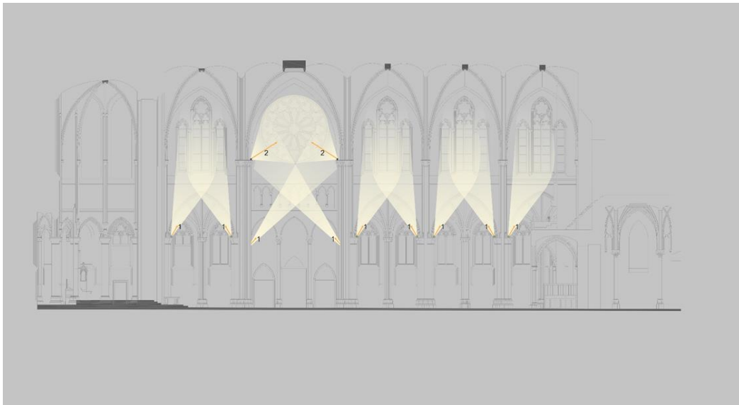
Slika 6.28 Skica načelnih pozicija rasvjetnih tijela za rasvjetu vitraja i rozeta, sa usmjerenjima snopova svjetlosti (presjek)
