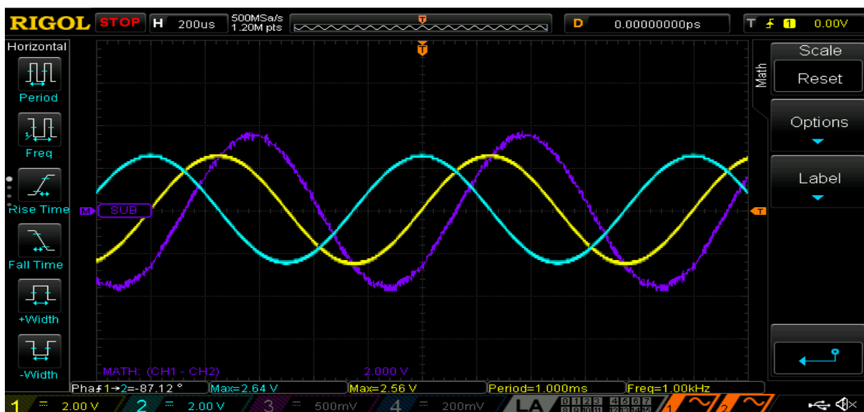
3.20. Prikaz oduzimanja valnih oblika na osciloskopu
