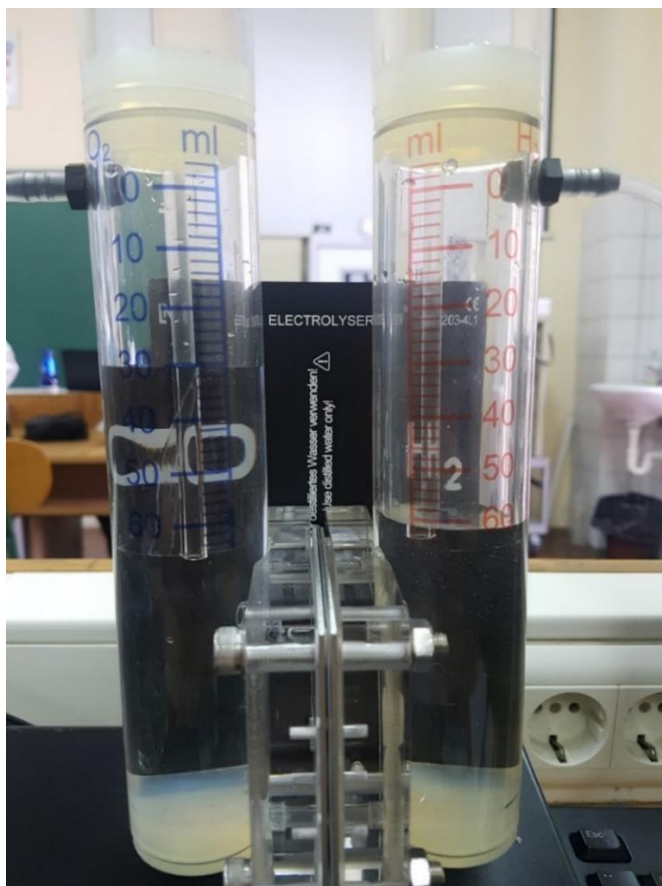
Slika 3.9. Spremnici plinova nakon završene elektrolize
