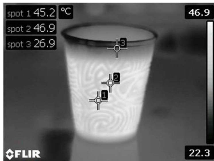
Slika 3.4. 3 Primjer termograma čašice s kavom
