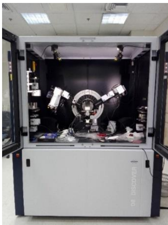
Slika 2.1 Difraktometar X – zraka Bruker D8 [3]
