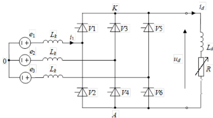
**Slika 4.2.** Shema spajanja punoupravljivog mosnog spoja.
