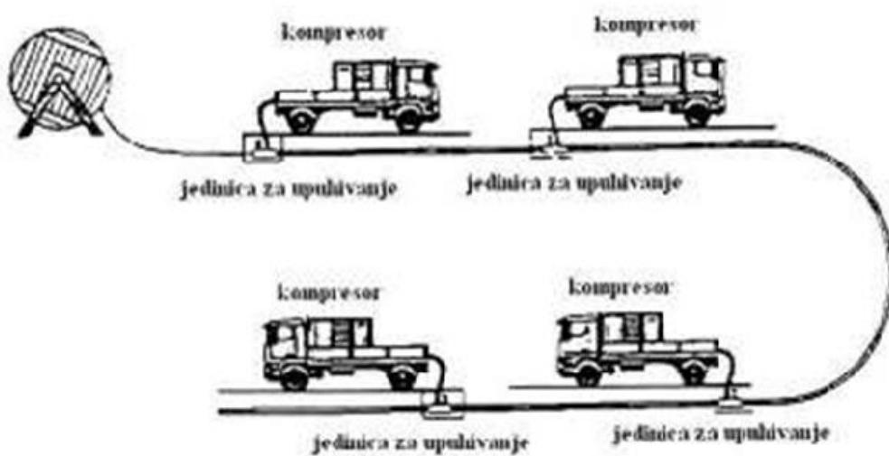
*Slika 5.5. Upuhivanje svjetlovodnog kabela u cijev(bez rakete)[2]*
