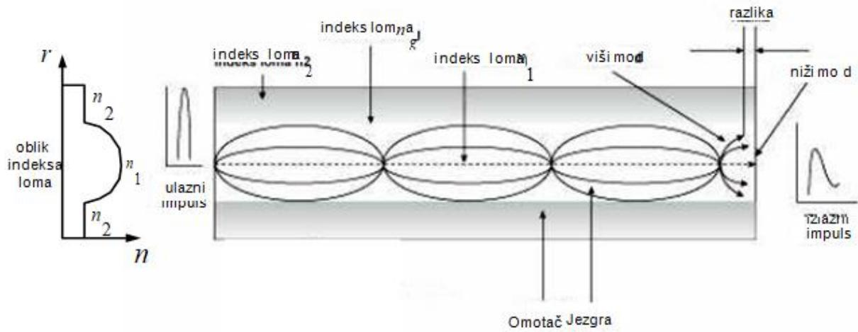
**Slika 4.9** Prikaz višemodnog svjetlovoda sa gradijentnim indeksom loma [2].
