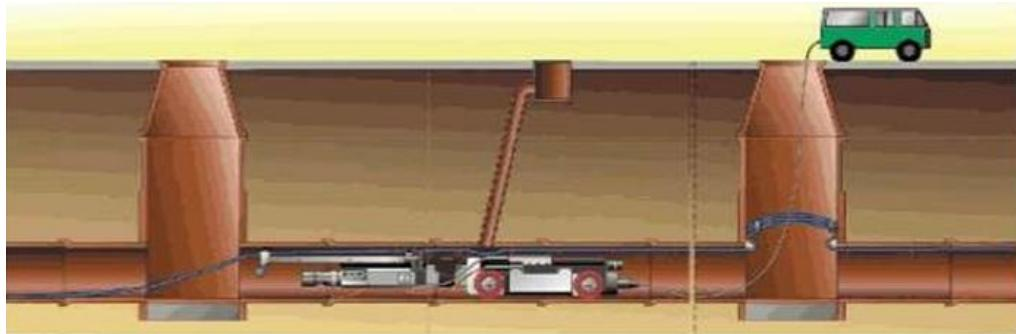
*Slika 5.6. Postavljanje kabela pomoću robota*
