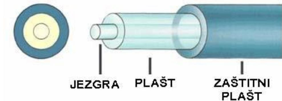
*Slika 4.6. Prikaz svjetlovodnog kabela[1].*
