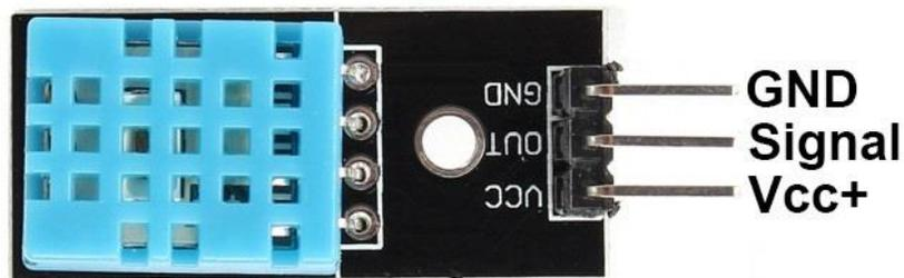
**Slika 3.3.** *DHT11 senzor[10]*
