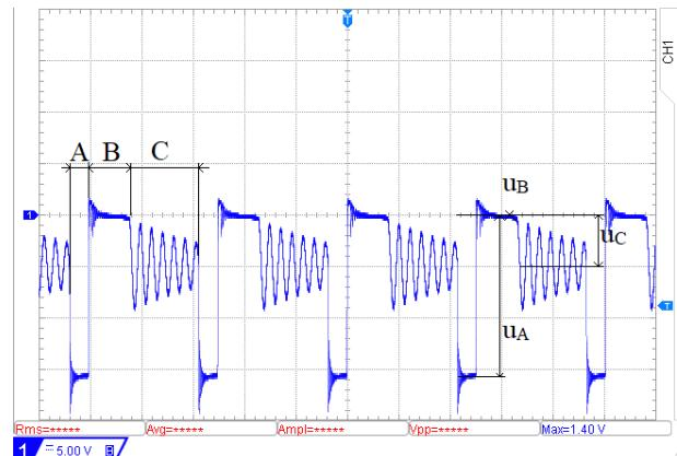
**Slika 4.6.** Valni oblik napona na neupravlјivom ventilu V2 pri  $150\text{V}$ :  $u_{V2}$
