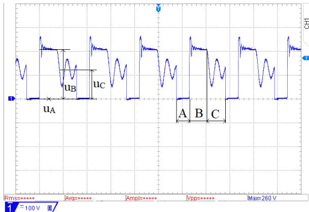
**Slika 4.3.** Valni oblik napona na upravlјivom ventilu V1 pri 100V:  $u_{V1}$
