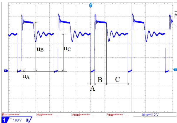
**Slika 4.7.** Valni oblik napona na upravlјivom ventilu V1 pri 200V:  $uv_1$
