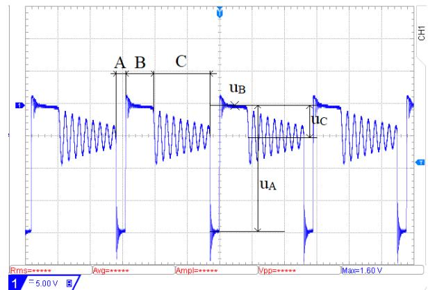
**Slika 4.8.** Valni oblik napona na neupravlјivom ventilu V2 pri 200V:  $uv_2$
