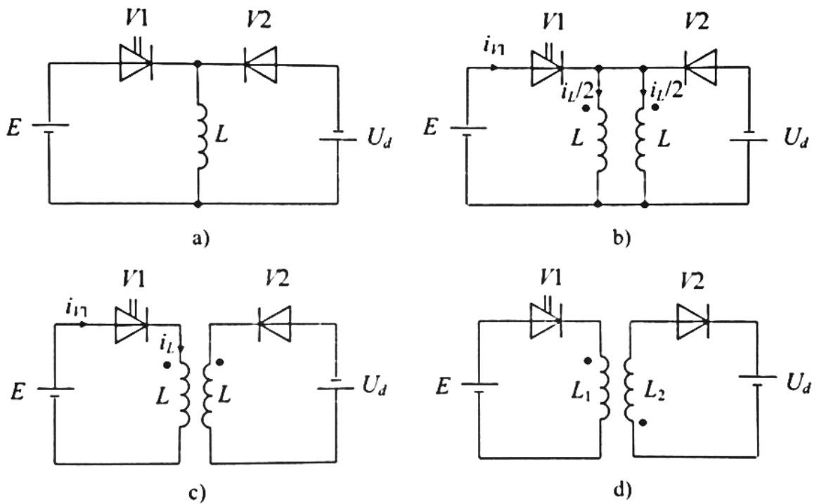
**Slika 2.1.** a) Induktivni istosmjerni pretvarač; b) Induktivitet  $L$  sastoji se od dva paralelno spojena savršeno magnetski vezana induktiviteta; c) Paralelno spojeni namoti su razdvojeni; d) Zaporni pretvarač
