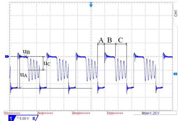
**Slika 4.4.** Valni oblik napona na neupravlјivom ventilu V2 pri 100V:  $u_{V2}$
