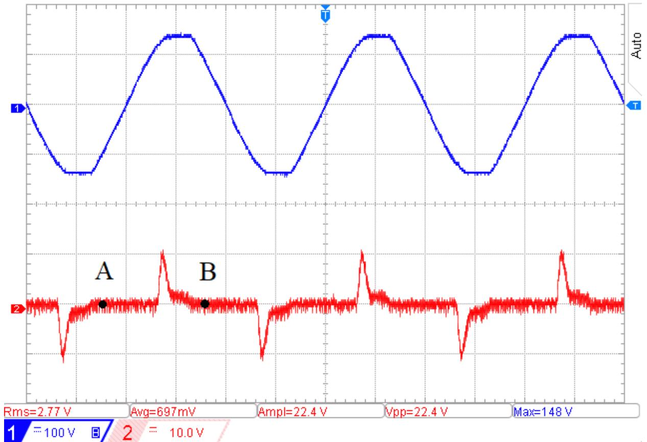
Slika 4.9. Valni oblici napona i struje na ulazu
