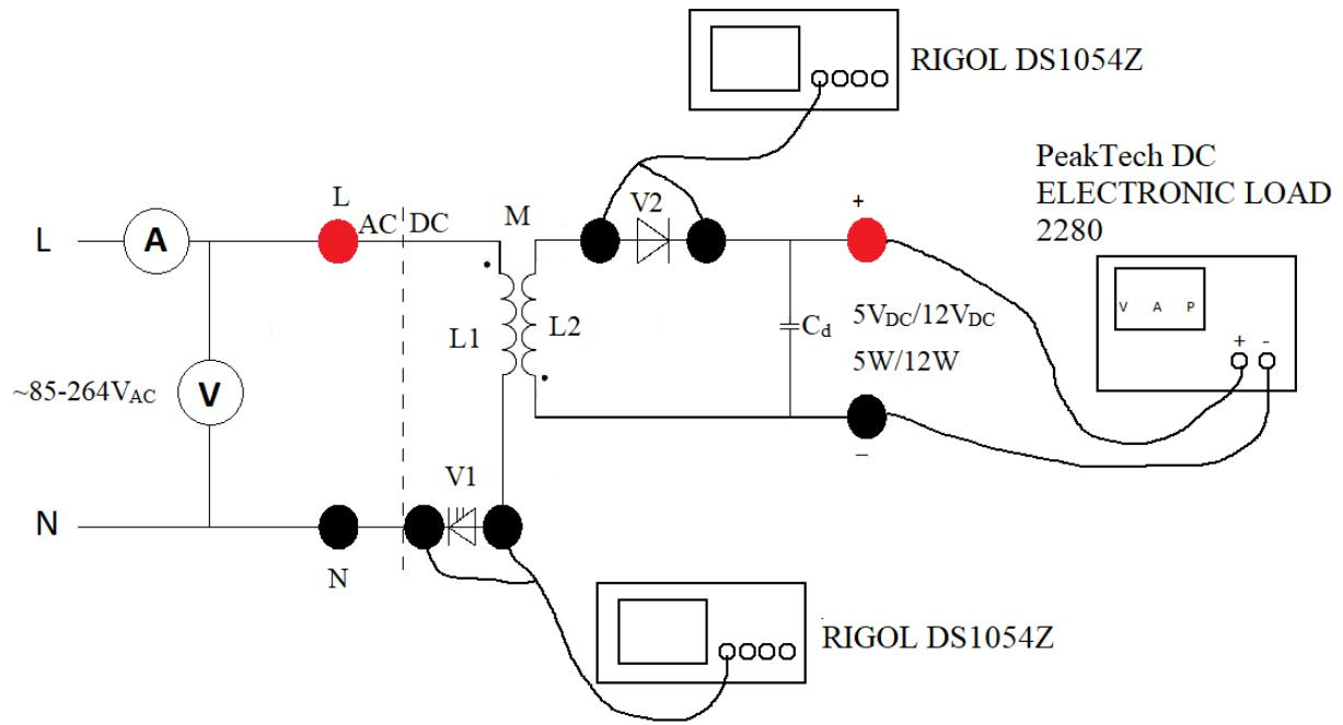
**Slika 4.2.** Shema spajanja mjernih instrumenata i programibilnog trošila
