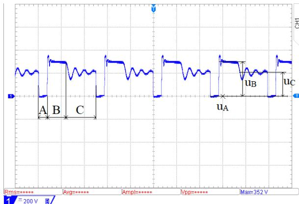
**Slika 4.5.** Valni oblik napona na upravlјivom ventilu V1 pri  $150\text{V}$ :  $u_{V1}$
