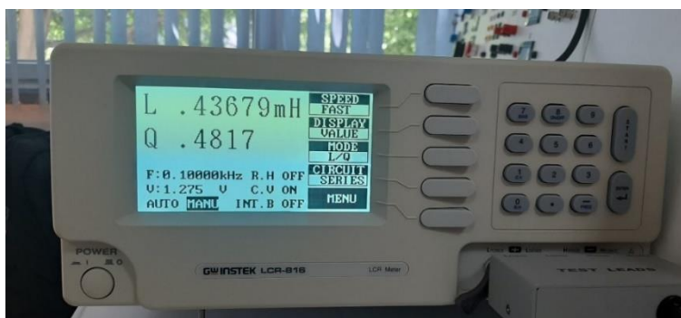
Slika 4. 14. Postavke instrumenta pri mjerenju zavojnice nazivnog induktiviteta 0,45[mH].
