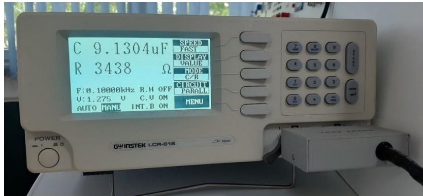
Slika 4. 30. Prikaz postavljenih postavki pri mjerenju parametara kondenzatora u paralelnom nadomjesnom spoju.
