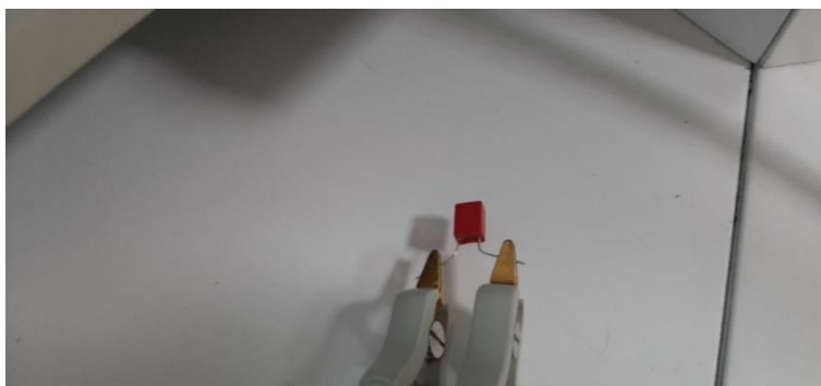
Slika 4. 23. Prikaz načina spajanja blok kondenzatora na priključke mjernog instrumenta.
