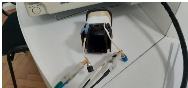
Slika 4. 13. Način spajanja priključaka instrumenta na zavojnicu nazivnog induktiviteta 45[mH].
