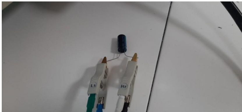
Slika 4. 31. Prikaz načina spajanja priključaka mjernog instrumenta na komponentu.
