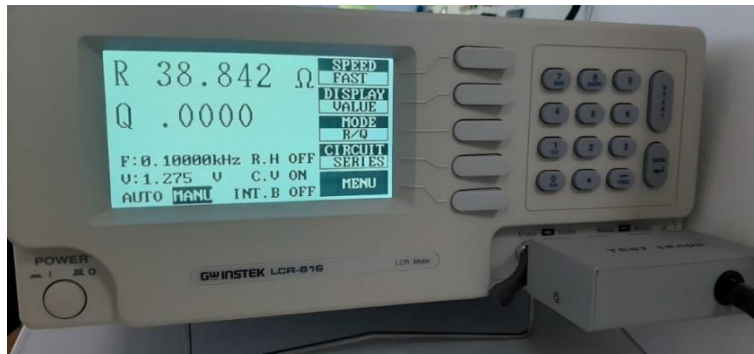
Slika 4. 4. Postavke korištene pri mjerenju parametara.
