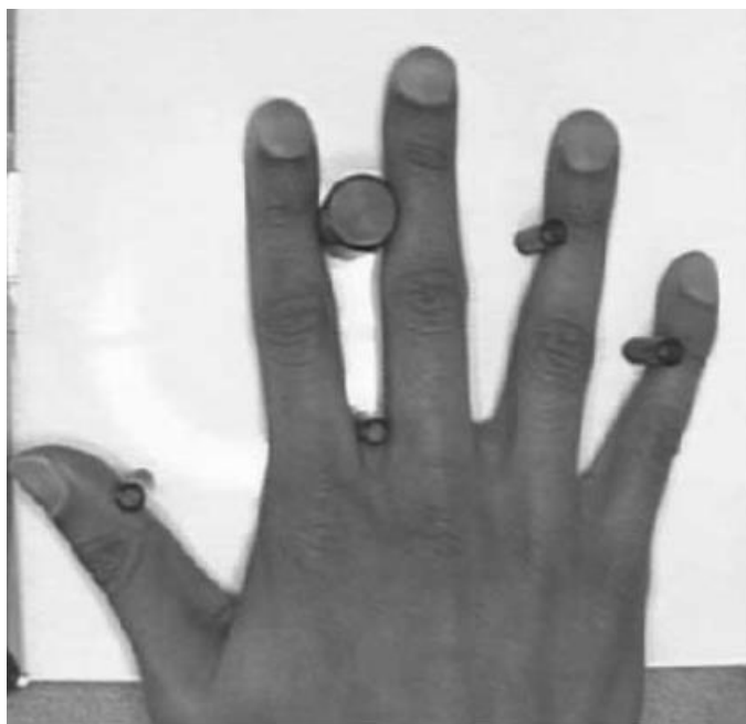
Slika 4.2. Položaj ruke na skeneru s valjcima (preuzeto s www.m2sys.com )
