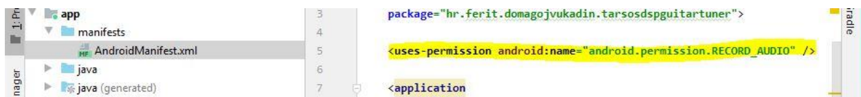
Slika 5.4. Dozvola sustava u Android Manifest datoteci
