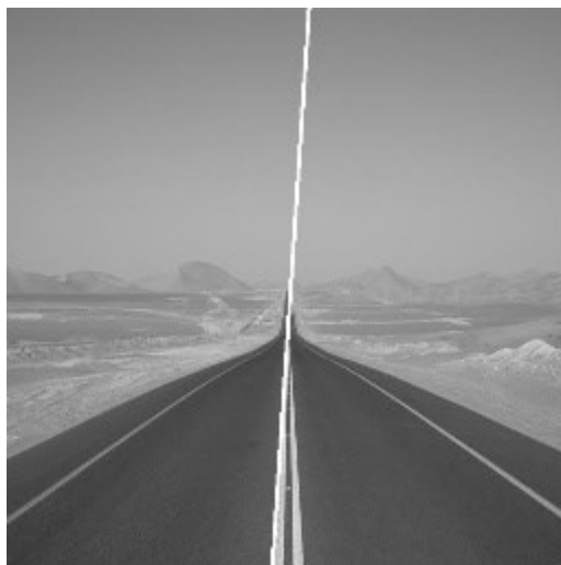
Sl. 7.19. Cesta sa slike 7.13. s ucrtanim detektiranim pravcem pomoću Hough-ove transformacije
