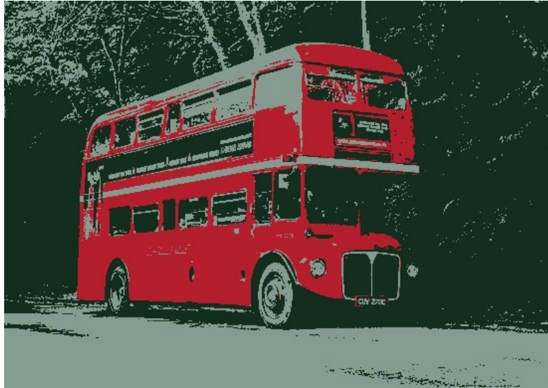
Sl. 7.30. Segmentirana slika crvenog autobusa pomoću segmentacije grupiranjem ( K = 3 )
