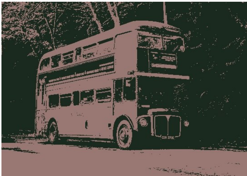
Sl. 7.31. Segmentirana slika crvenog autobusa pomoću segmentacije grupiranjem ( K = 2 )
