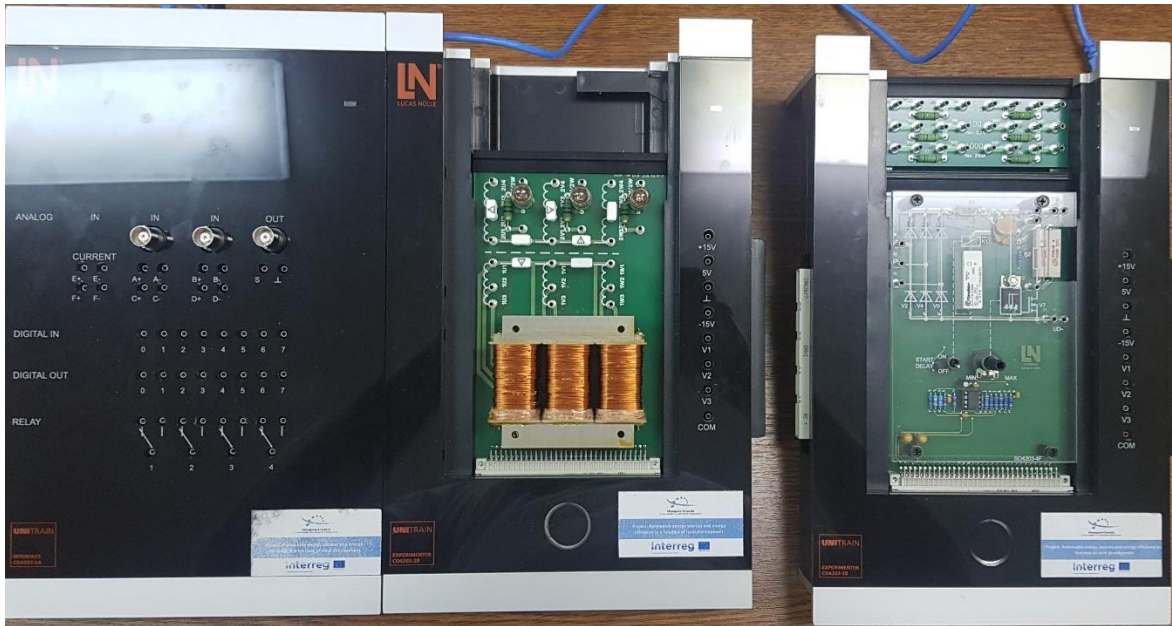
Slika 4.1 LN upravljačka ploča i eksperimentalne kartice transformatora ispravljača
