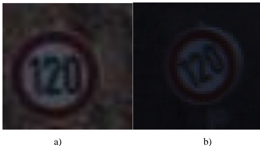
Slika 6.7. Slike na kojima je prepoznavanje neuspješno obavljeno od ukupnog uzorka od 100 testnih slika: a) Ograničenje brzine (120 km/h) pogrešno prepoznato kao ograničenje brzine (80 km/h), b) Ograničenje brzine (120 km/h) pogrešno prepoznato kao ograničenje brzine (80 km/h)
