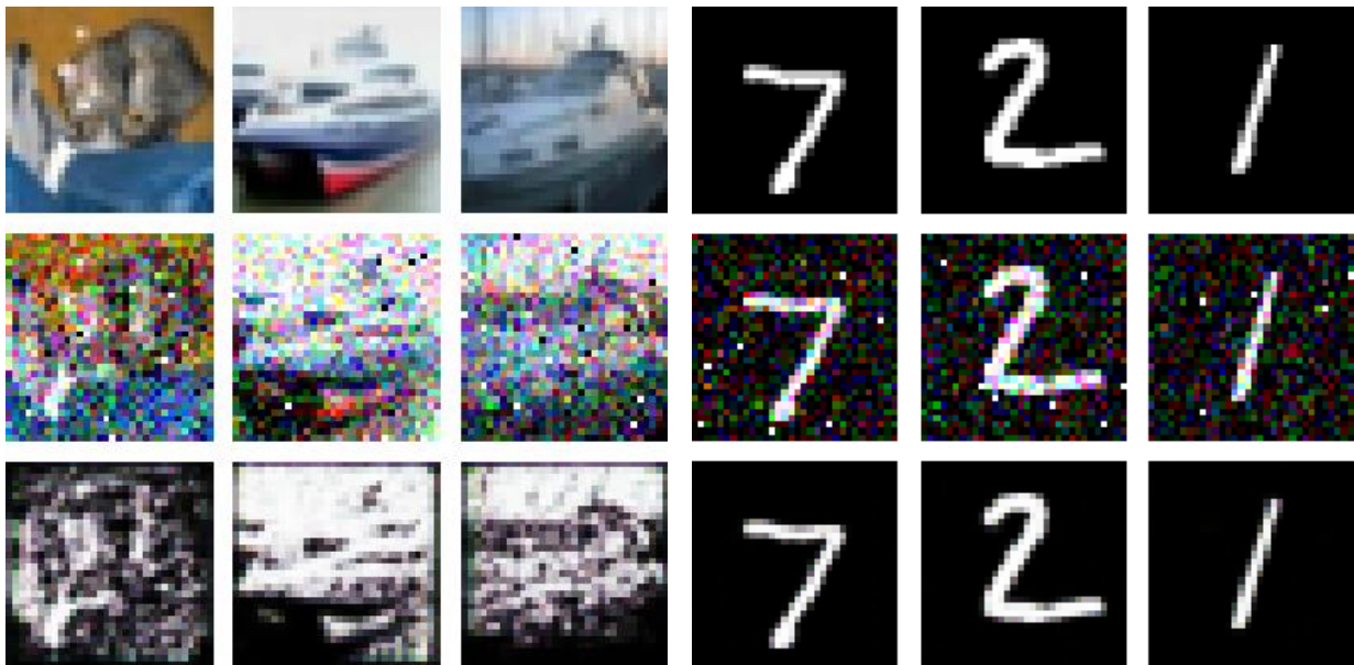
Slika 4.3: Uklanjanje šuma modelom treniranim na MNIST bazi slika
