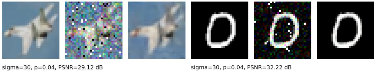
Slika 4.15: Uklanjanje šuma sa \sigma = 30 i p = 0.04
