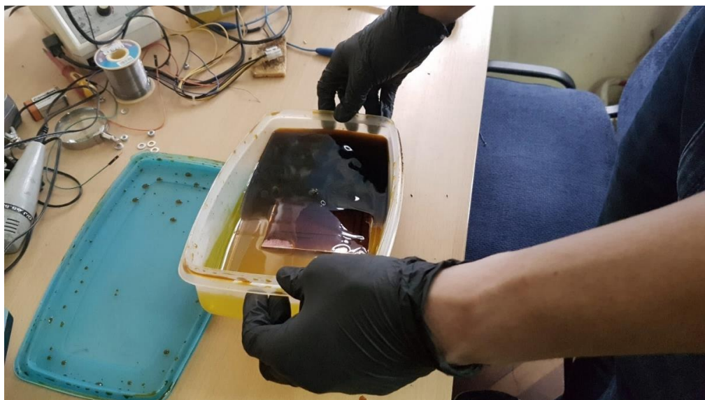
Slika 3.3. Nagrizanje (jetkanje) tiskane pločice u kiselini.
