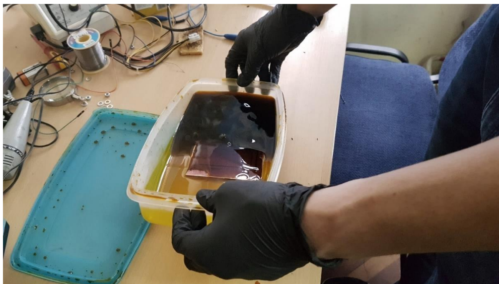
Slika 3.3. Nagrizanje (jetkanje) tiskane pločice u kiselini.
