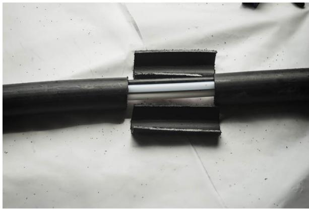
Slika 5.14: Odrezani dio PE50 cijevi s mikrocijevima
