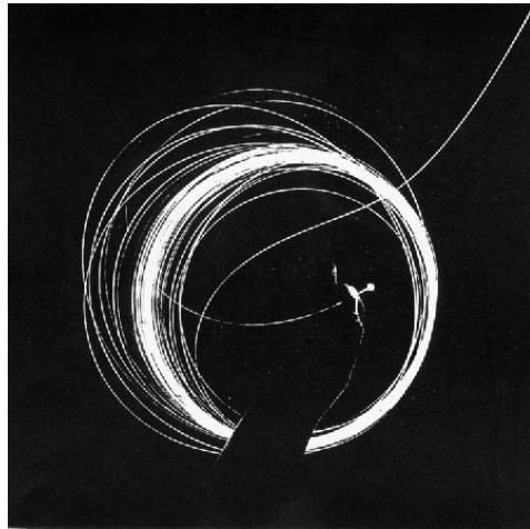
Slika 2.4: Fotografija propagacije svjetlosti dugim optičkim vlaknom, [6]
