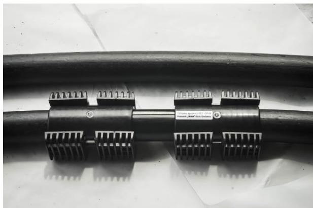
Slika 5.13: Reparirana PE50 cijev s uvučenim mikrocijevima
