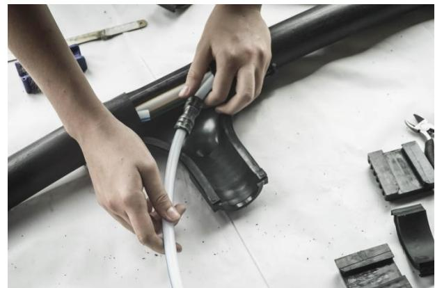
Slika 5.17: Spajanje mikrocijevi konektorom za mikrocijevi
