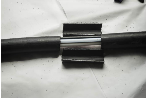
Slika 5.14: Odrezani dio PE50 cijevi s mikrocijevima
