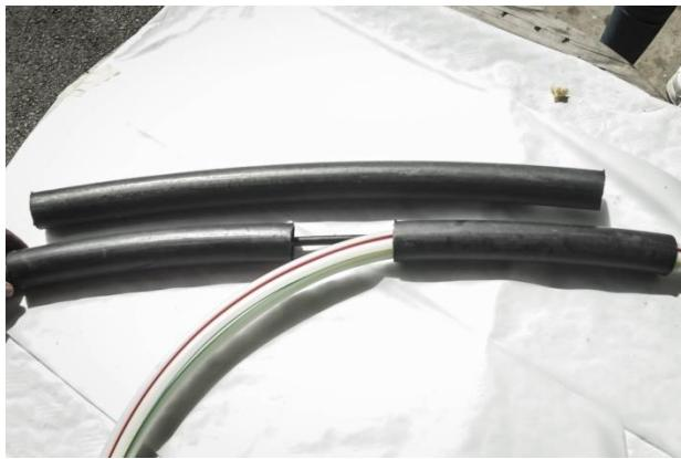
Slika 5.3: Snop mikrocijevi uvučen u jednu stranu cijevi
