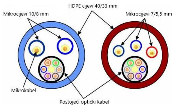
Slika 4.3: Presjek cijevi, [19]
