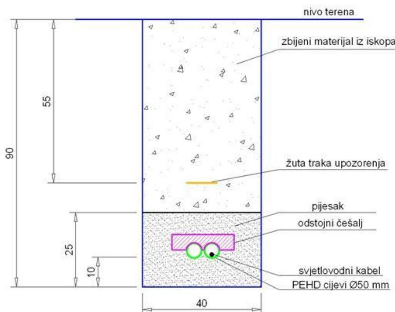
Slika 4.22: Presjek rova kabelske kanalizacije [26]
