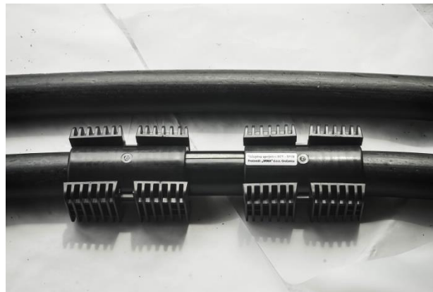
Slika 5.13: Reparirana PE50 cijev s uvučenim mikrocijevima
