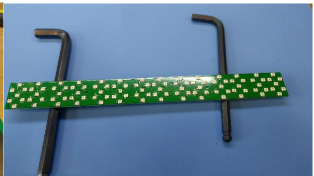
Slika 3.6 Postavljanje diode prije lemljenja
