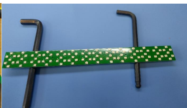
Slika 3.6 Postavljanje diode prije lemljenja
