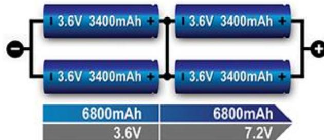
*Slika 3.8. Serijsko – paralelni spoj ćelija [12]*
