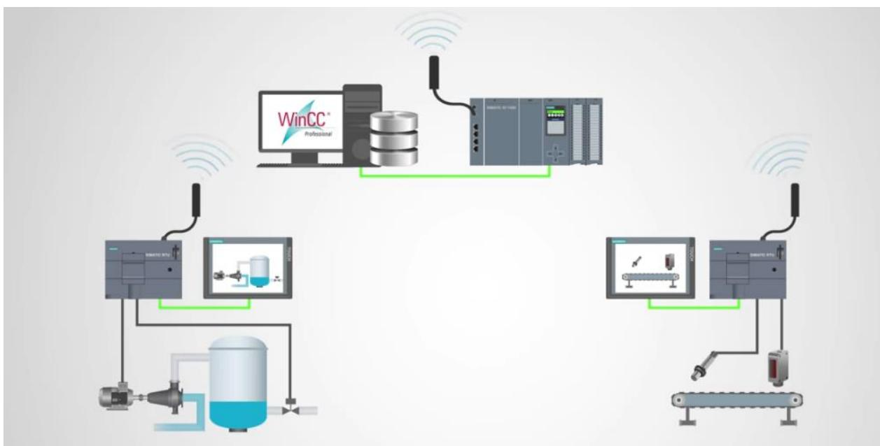
Slika 2.40. Komunikacija uređaja u SCADA sustavu [24]
