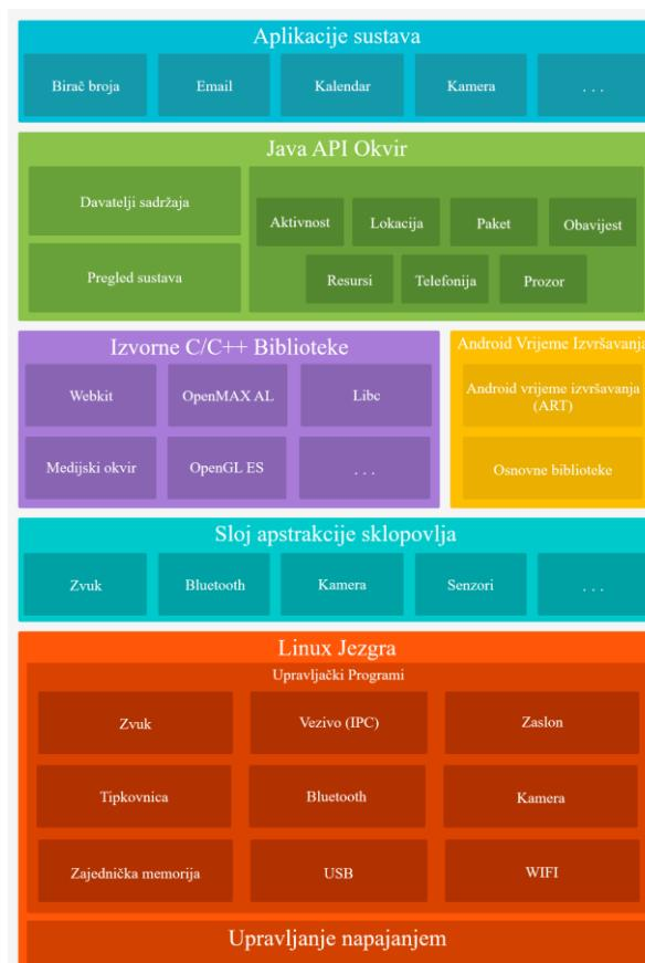
Slika 3.2. Dijagram glavnih komponenti Android platforme, izrađen prema [22]
