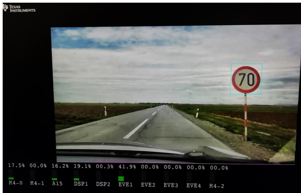
Sl. 3.16. Prikaz scene i detektiranog prometnog znaka nakon implementacije Object Detection algoritma na ALPHA ploči
