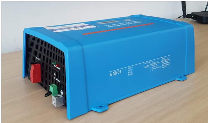
Slika 4.6. Otočni izmjenjivač Phoenix 24/800
