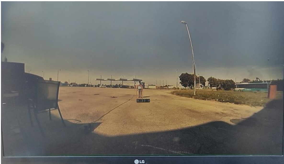
Sl. 3.18. Prikaz na ekranu dobiven kad se pokrene slučaj upotrebe za procjenu udaljenosti pješaka koristeći jednu kameru na vozilu
