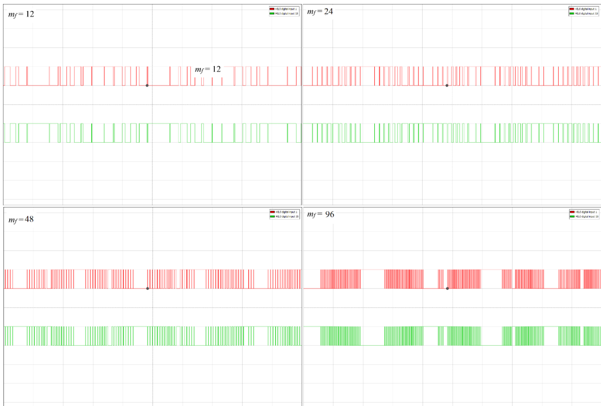
Slika 5.19. Usporedba upravljačkih signala pri različitim m_f , m_a = 1.0 .
