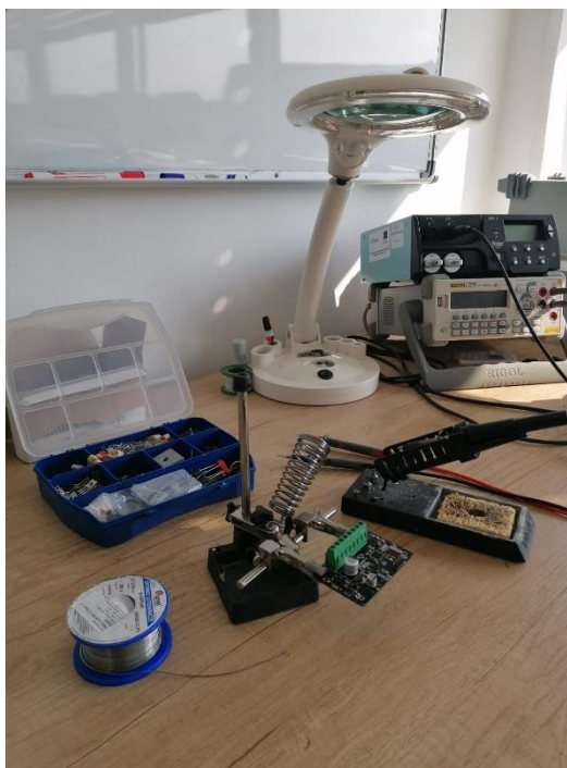
Slika 3.12. Izrađena pločica spremna za lemljenje
