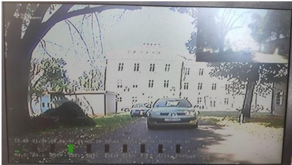
Sl. 4.7. Prikaz izlaznog signala na ekranu za korisnički slučaj s uvećavanjem dijela slike – drugi stupanj uvećanja
