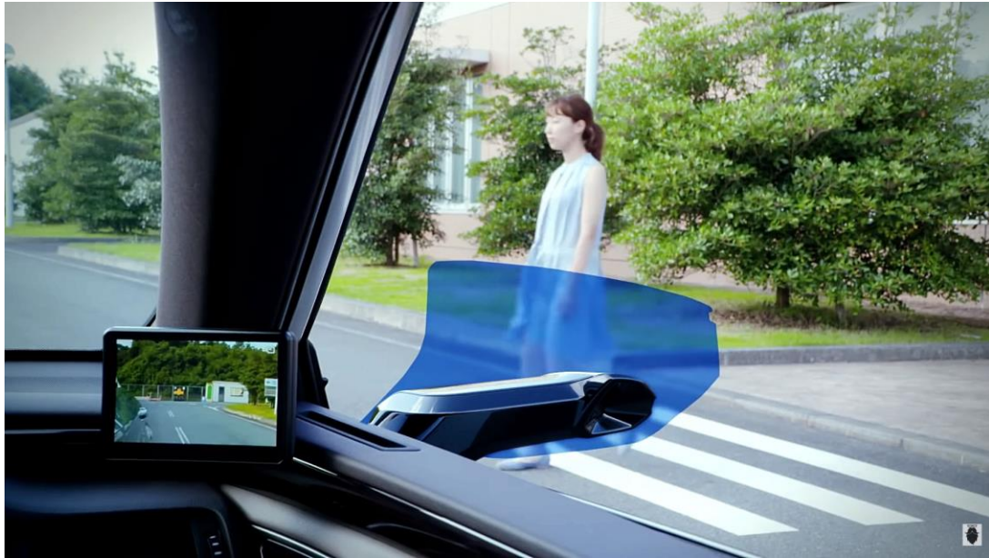
Sl. 2.4. Prikaz razlike konvencionalnog i modernog zrcala – Lexus ES 300h.
