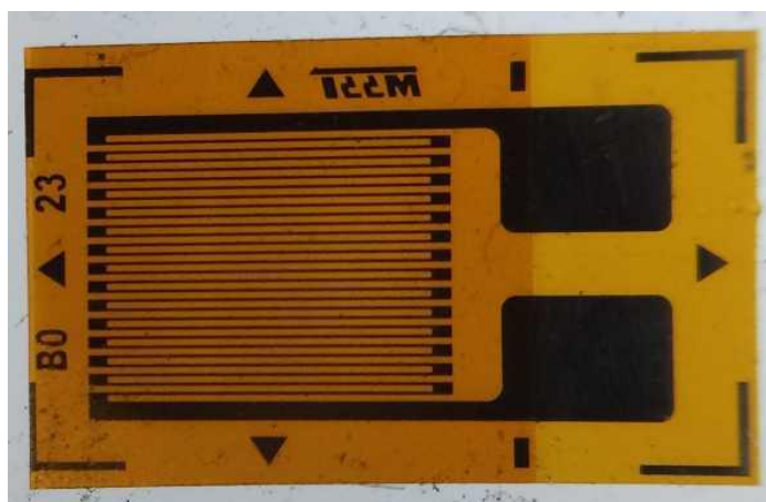
Sl. 3.10. Tenzometar u obliku metalne folije 13
