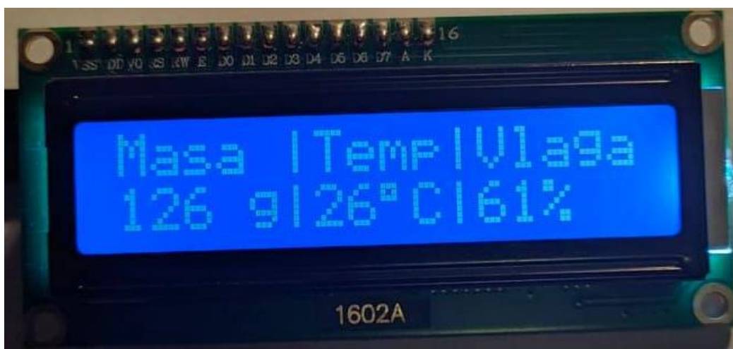
Sl. 5.1. Ispis mjerenih vrijednosti na LCD zaslon
