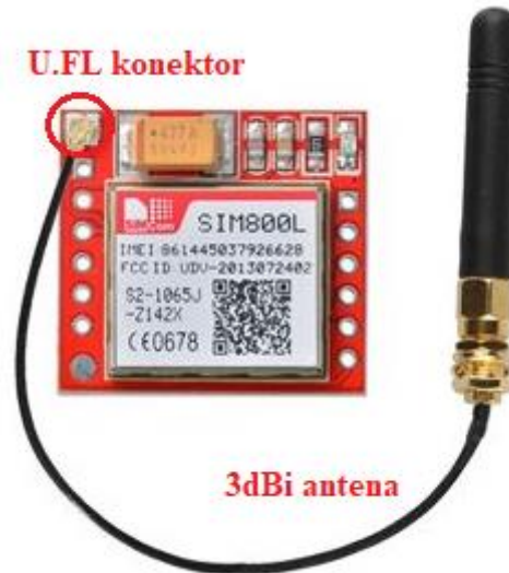
Sl. 3.7. SIM800L modul sa spojenom 3dBi antenom 10
