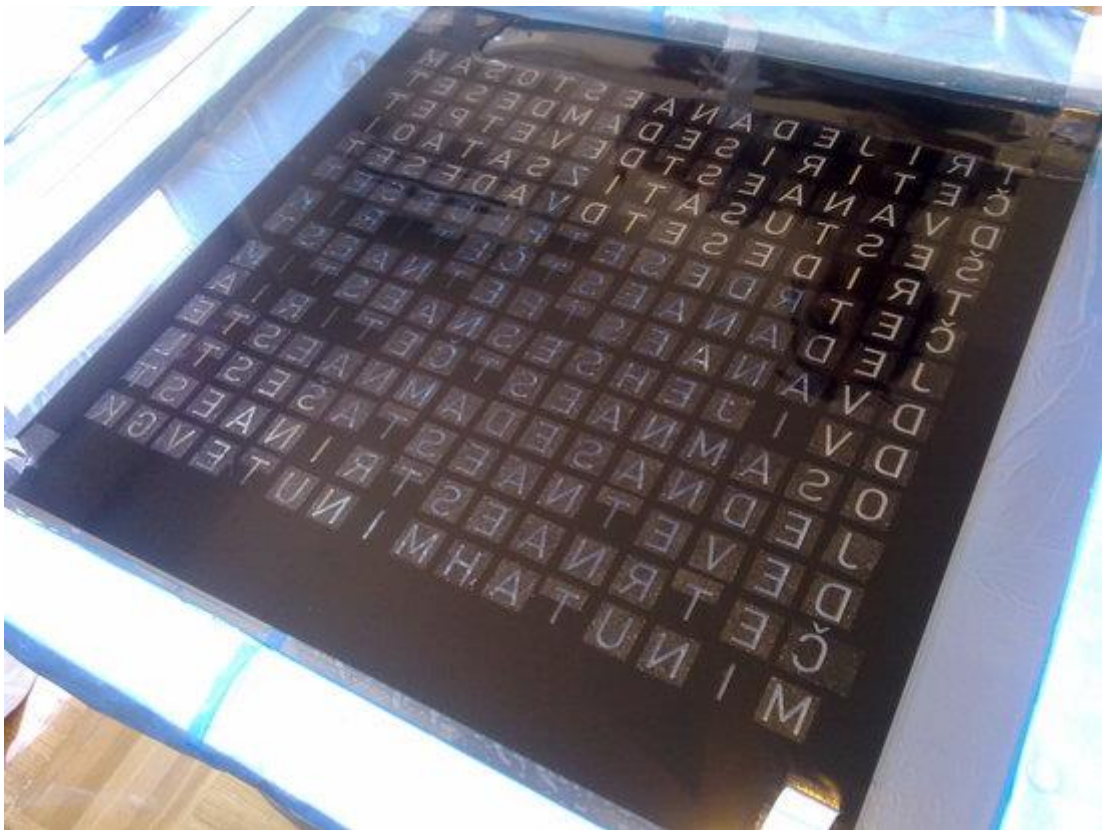
Slika 3.24: Lijepljenje folije na staklo [9]
