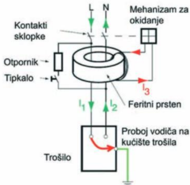
Slika 6.3.1. Princip rada RCD sklopke, [7].
