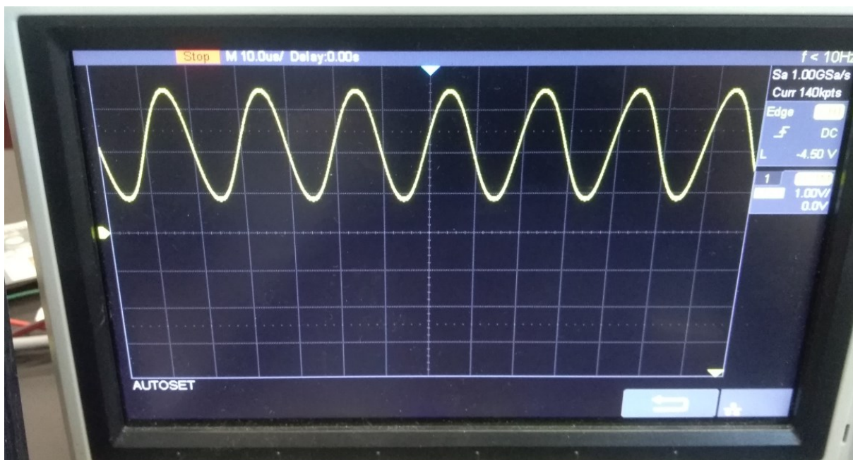
Slika 4.3.2 „Uspješno generirani sinusni signal 2V p-p 50 kHz“
