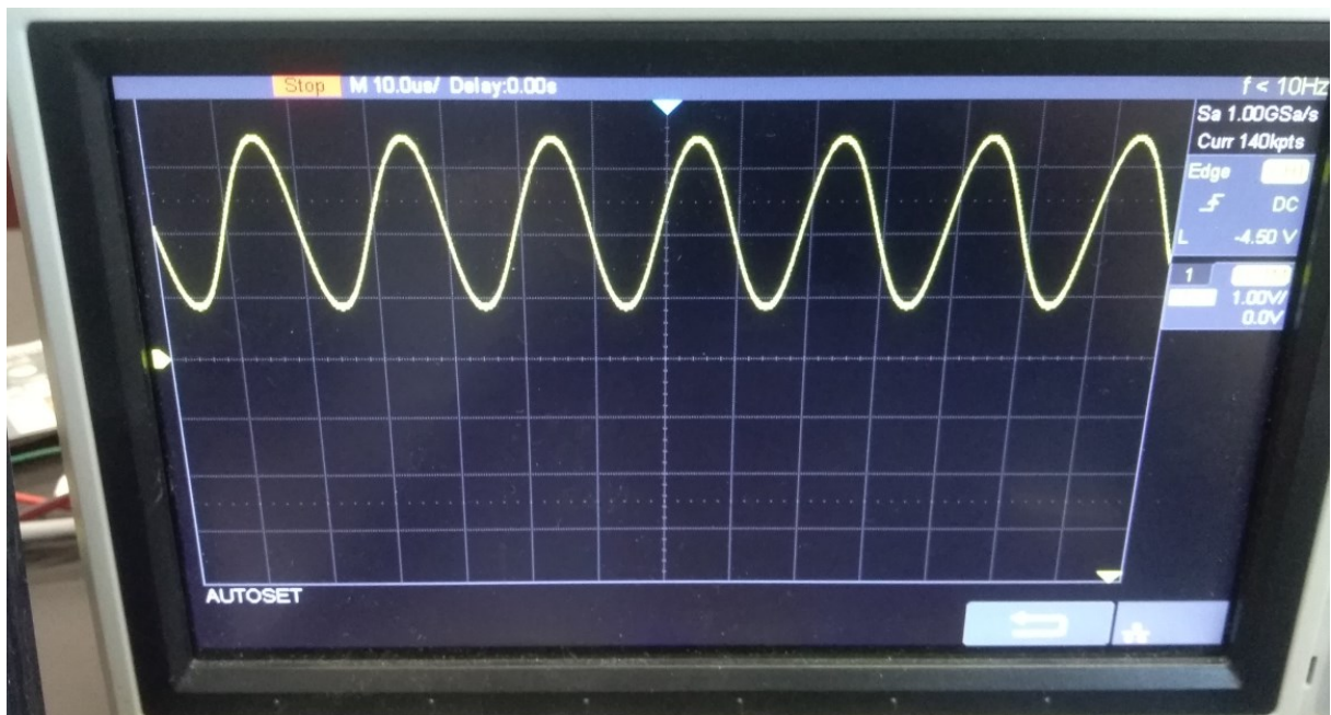
Slika 4.3.2 „Uspješno generirani sinusni signal 2V p-p 50 kHz“
