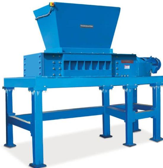
**Slika 4.1.** Sjeckalica (e. *shredder*) za usitnjavanje otpada tvrtke Franklin Miller [20]
