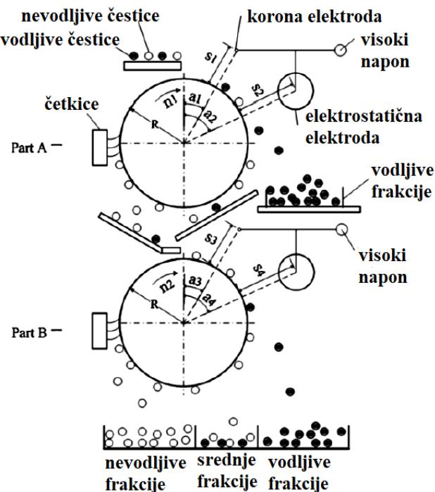
**Slika 2.13.** Elektrostatički postupak [16]
