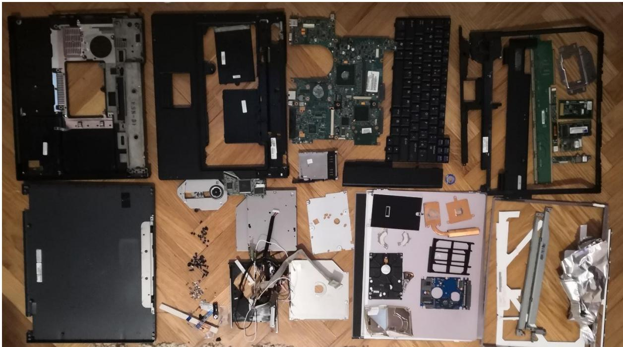
Slika 3.4. Prijenosno računalo HP T60M283.00 rastavljeno u dijelove
