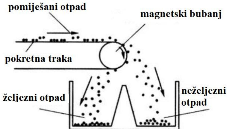
**Slika 2.10.** Fero-magnetski postupak [7]
