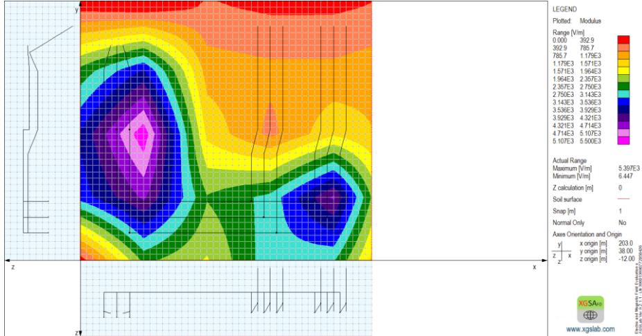
**Slika 5.9.** 2D prikaz raspodjele električnog polja u postrojenju
