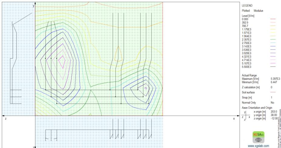
Slika 5.14. Konturni prikaz raspodjele električnog polja u postrojenju
