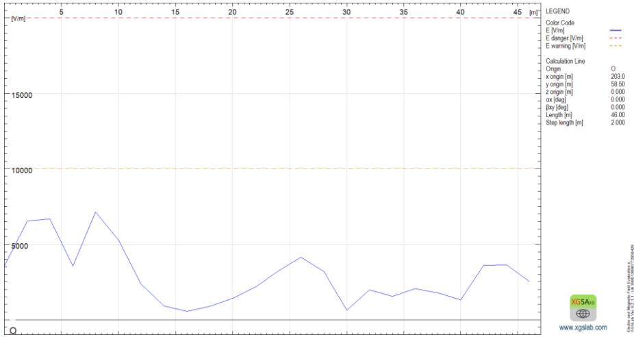
**Slika 5.15.** Linijski prikaz raspodjele električnog polja u postrojenju
