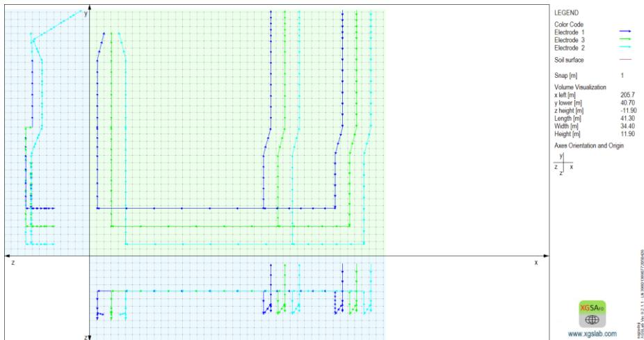
**Slika 5.3.** 2D prikaz postrojenja s prikazanim smjerovima struja
