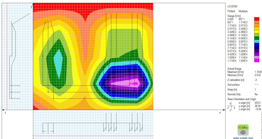
**Slika 5.17.** 2D prikaz raspodjele električnog polja u postrojenju na visini 2 m
