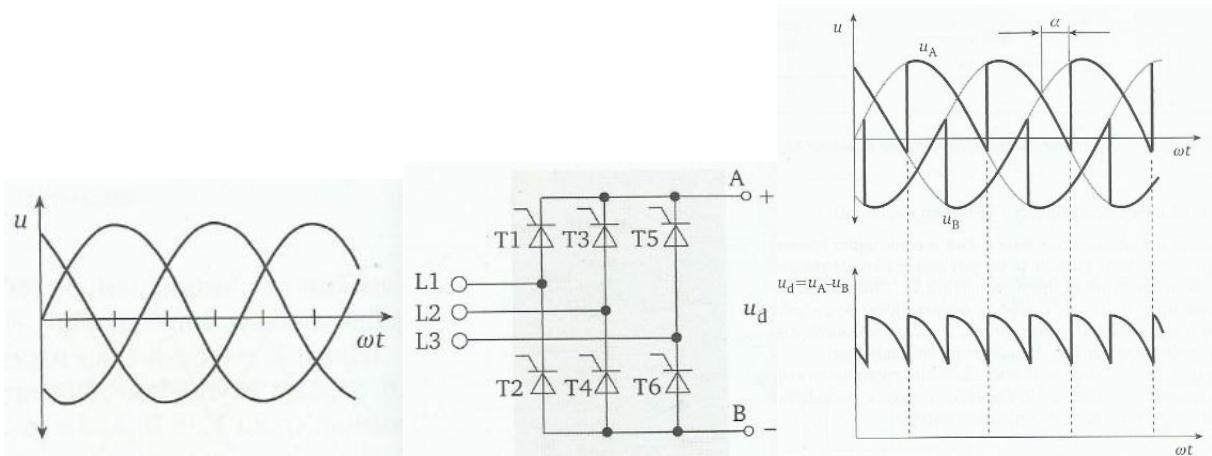
**Slika 2.6.** Punoupravlјivi ispravljač u trofaznom mosnom spoju sa ulaznim i izlaznim naponom
