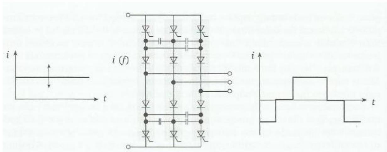
**Slika 2.9.** Izmjenjivač s promjenjivim naponom strujnog međukruga [2]
