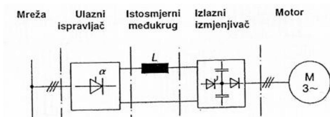
**Slika 2.7.** Shema frekvencijskog pretvarača sa strujnim istosmjernim međukrugom [6]
