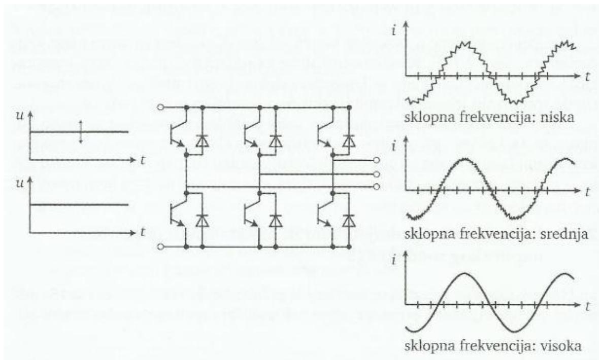
**Slika 2.10.** Izmjenjivač s utisnutim promjenjivim ili konstantnim naponom [2]
