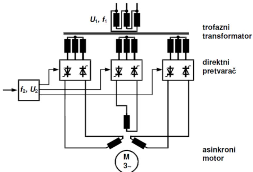
Slika 2.2. Shematski prikaz direktnog pretvarača [4]
