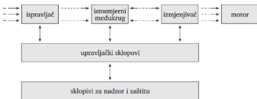
Slika 2.4. Pojednostavljena blokovska shema neizravnog frekvencijskog pretvarača [2]
