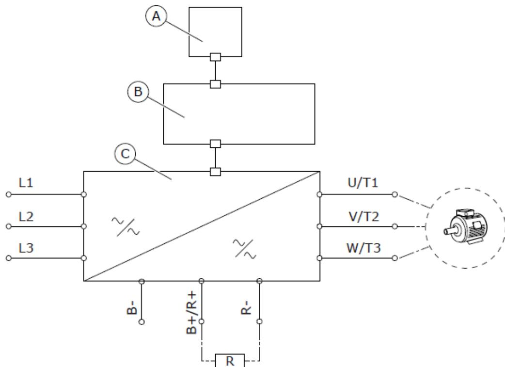
**Slika 3.9.** Blok shema frekvencijskog pretvarača sa označenim stezaljkama [11]
