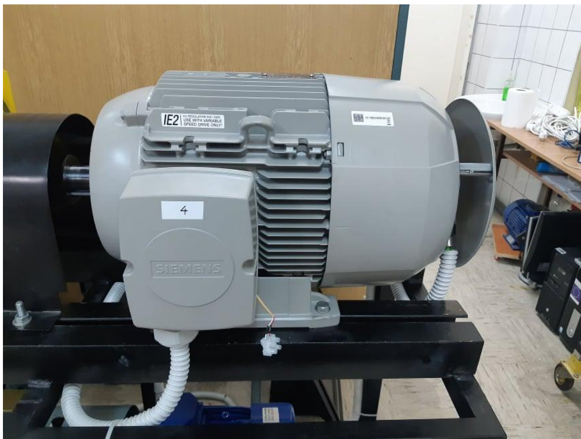
Slika 3.6. Trofazni asinkroni motor u učionici za laboratorijske vježbe
