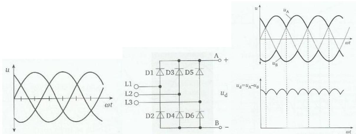
**Slika 2.5.** Neupravljeni punovalni ispravljač u trofaznom mosnom spoju sa ulaznim i izlaznim naponom [2]
