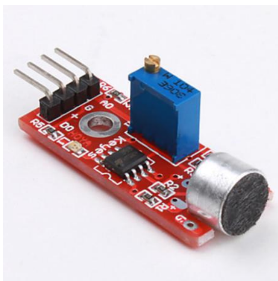
Slika 3.5 LM393 zvučni senzor modul
