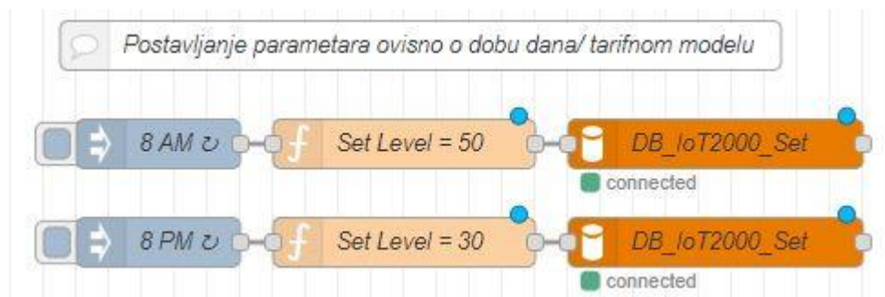
Slika 5.51 Prikaz tokova za postavljanje parametara procesa ovisno o dobu dana
