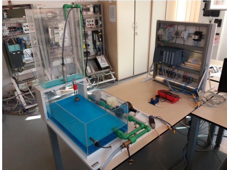
Slika 3.4 Maketa održavanja temperature i razine tekućine u spremniku s razvodnom pločom
