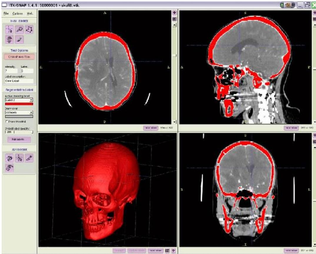
**Slika 3.3 :** Prikaz segmentacije lubanje korištenjem ITK-SNAP-a. Izvor slike: [56]
